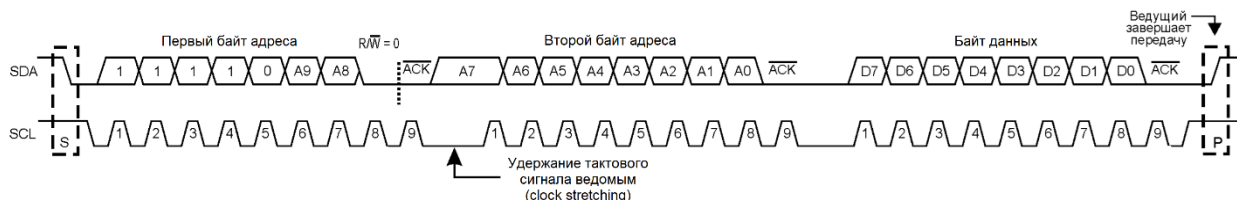
Рисунок 84 – Передача по I2C в 10-битном режиме
